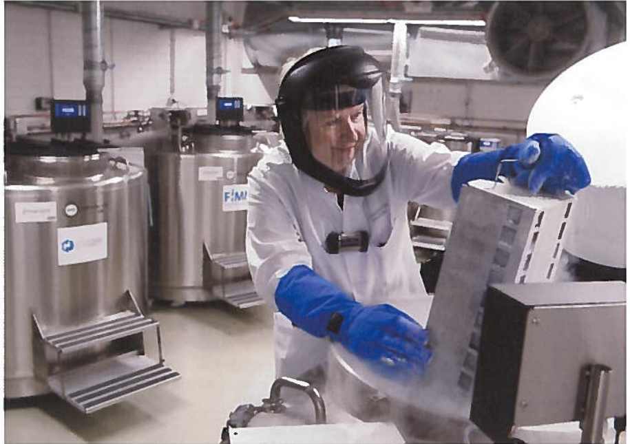
Biopankkinäytteitä säilytetään nestetypen kaasufaasissa -180^{\circ}\text{C} lämpötilassa.
