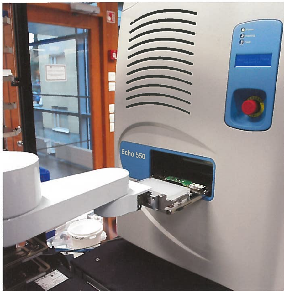
Tehoseulonnassa sadat lääkeaineet siirretään 384- tai jopa 1536-kuoppalevyille tarkan ääniaaltaja käyttävän teknologian avulla.
