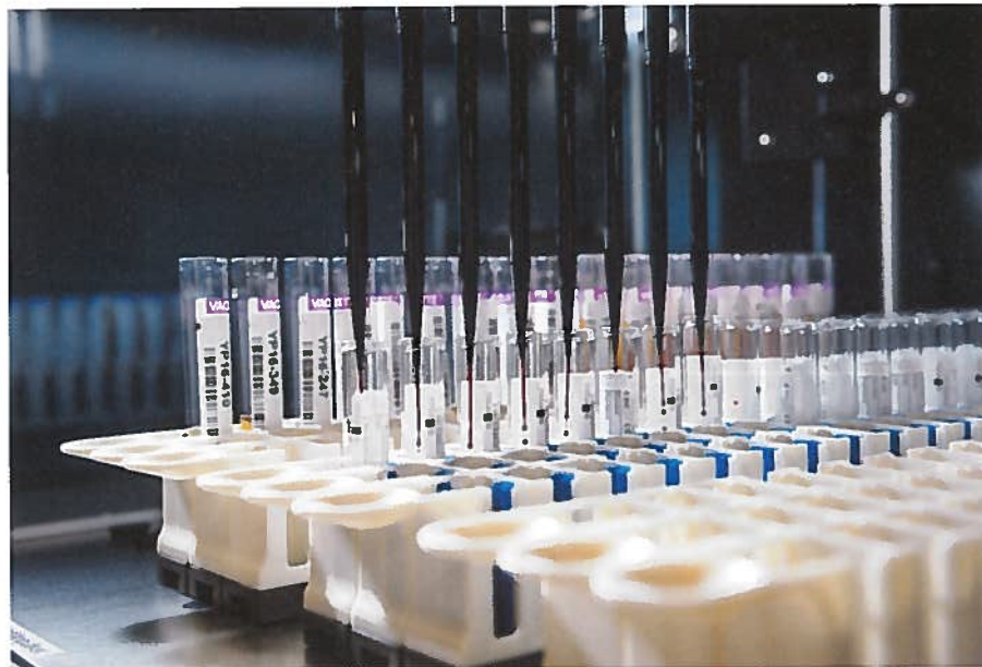
Helsingin Biopankissa näytteen prosessoinnista huolehtii nesteenkäsittelyrobotti.
