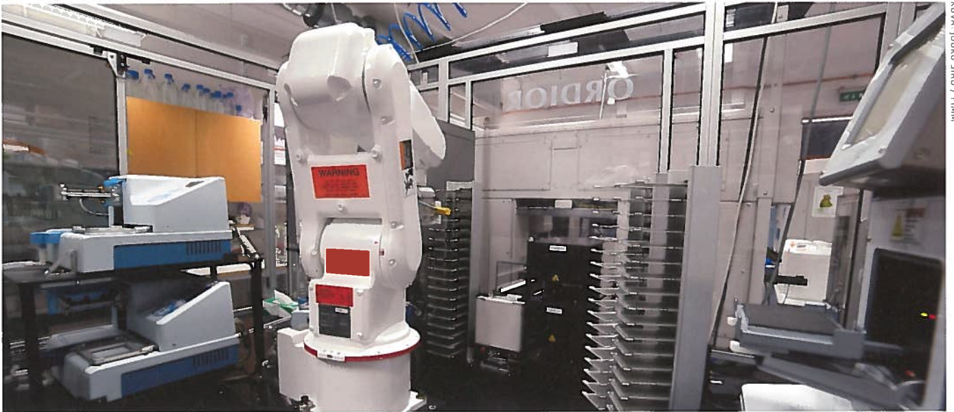
Henkilökohtaisen lääketieteen tutkimushankkeissa tutkitaan potilaan syöpäsolujen vastetta yli viidellesadalle lääkeaineelle robotiikan avulla FIMMin tehoseulontayksikössä.
